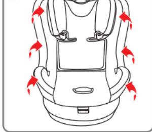
Volver a colocar con cuidado el revestimiento en su sede por el borde del apoyacabezas. Enganchar los botones automáticos de la tela del apoyacabezas y del asiento.
