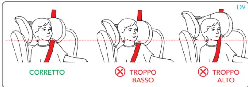
При использовании 3-х точечного ремня безопасности автомобиля подголовник необходимо отрегулировать таким образом, чтобы между ним и плечами ребенка оставалось расстояние в два пальца. Проследите за тем, чтобы нагрудный защитный ремень, пропущенный через «проушину направляющей нагрудного ремня» скобу от подголовника, располагался на уровне плеч, а не шеи ребенка
