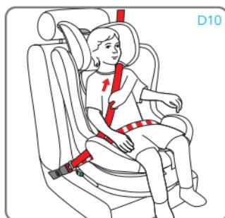
Tensar el cinturón como se indica en la figura. Asegurarse de haber colocado el cinturón abdominal lo más abajo posible, sobre la pelvis del niño, de haberlo introducido en las guías del cinturón de seguridad abdominal y de haber enganchado correctamente la hebilla. El cinturón pectoral debe pasar por su guía correspondiente.
