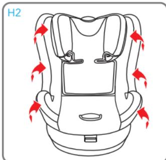
Remover, fazendo deslizar cuidadosamente, o tecido da estrutura começando por um dos lados. Prestar atenção durante o deslizamento do tecido da guia de passagem do cinto abdominal.
