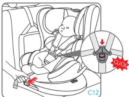
Installer l'enfant dans le siège-auto. Positionner les bretelles par-dessus les épaules de l'enfant, réunir les deux languettes de la ceinture et les attacher à la boucle. **IMPORTANT!** Un bon réglage de l'appuie-tête assure une protection maximale à l'enfant dans le siège-auto.
