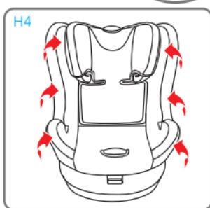
Επανατοποθετήστε με προσοχή το κάλυμμα κατά μήκος του άκρου του στηρίγματος κεφαλής, στη θέση του. Κουμπώστε τις σούστες του υφασμάτος στο στήριγμα κεφαλής και στο κάθισμα.
