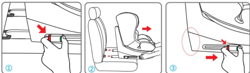
Premir simultaneamente ambos os lados do botão, o indicador ISOFIX ficará vermelho (fig. 1). Repetir esta operação em ambos os botões de desengate ISOFIX.
