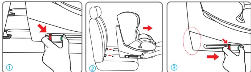
Одновременно нажмите на обе стороны кнопки, после чего индикатор ISOFIX станет красным (рис. 1). Повторите эту операцию с обеими кнопками расцепления ISOFIX. Отстегнув соединители ISOFIX, позвольте креплениям скользить вдоль каркаса, чтобы дать им возможность убраться внутрь (рис. 2).
