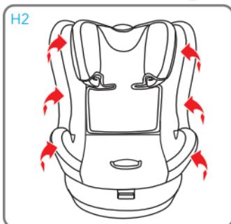
Осторожно снимите тканевую обивку с каркаса, начиная с боковой стороны; соблюдайте особую осторожность при отделении обивки от направляющей, через которую продевается поясной ремень. Отделите от обивки паховый ремень и снимите ее.
