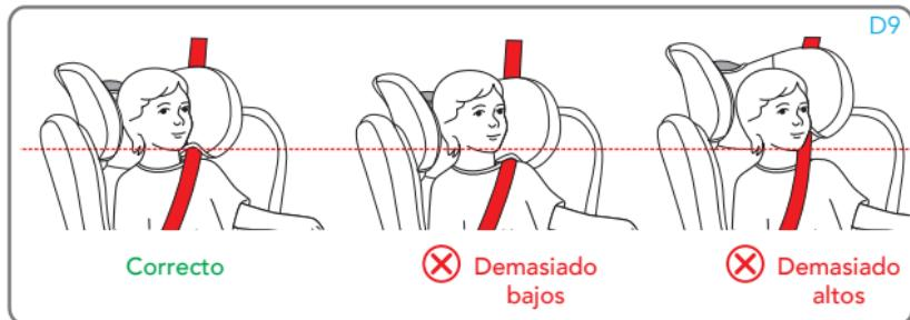
Cuando se utiliza el cinturón de seguridad de 3 puntos del vehículo, el apoyacabezas debe regularse de forma que haya un espacio de dos dedos entre el apoyacabezas y los hombros del niño. Asegurarse de que el cinturón de seguridad pectoral, al pasar por la "guía del cinturón pectoral" en el lateral del apoyacabezas, quede situado a la altura de los hombros y no del cuello del niño.
