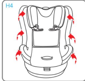
Recolocar cuidadosamente o revestimento ao longo da borda do apoio da cabeça, no seu local. Engatar os botões automáticos do tecido do apoio da cabeça e do assento.
