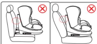
Σπρώξτε το παιδικό κάθισμα προς το κάθισμα αυτοκινήτου και βεβαιωθείτε ότι και οι δύο σύνδεσμοι ISOFIX έχουν επιμηκυνθεί μέχρι την ίδια θέση. Δεν πρέπει να υπάρχει κενό ανάμεσα στην πλάτη του καθίσματος του αυτοκινήτου και του παιδικού καθίσματος αυτοκινήτου.
