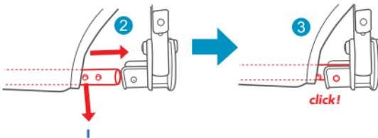
**IMPORTANTE:** asegúrese de que el perno metálico esté correctamente bloqueado en su sitio; un "clic" indicará que el bloqueo se ha realizado correctamente.
