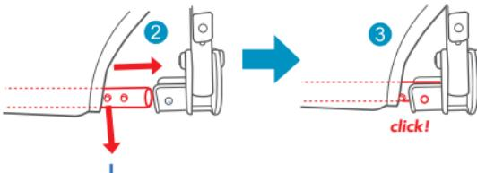
**IMPORTANT:** Asigurați-vă că acul metalic este fixat corect în orificiul său. Dacă veți auzi un „click” înseamnă că s-au fixat corect.
