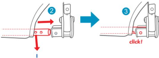
**IMPORTANT:** contrôlez que l'axe métallique est correctement bloqué dans son logement ; on entend un «clic» quand la fixation est assurée.
